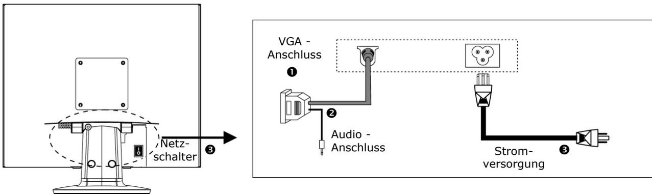
(Abb.: Rückseite Anschlüsse)
