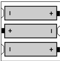
Legen Sie 3 Mignon 1,5 V-Batterien LR 03, Größe AAA (nicht mitgeliefert) in das Gerät ein. Die Batterien dienen zur Datenspeicherung bei einem Stromausfall.
