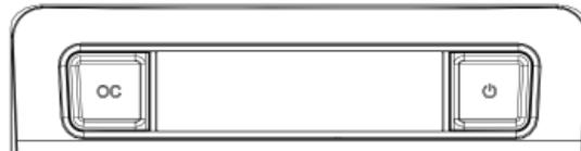
Verfügt Ihr Computer über einen OC Schalter an der Frontblende, übertakten Sie den Prozessor, indem Sie den Schalter drücken und dieser einrastet.
