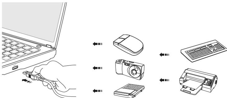
Die Datentransferrate liegt unter USB 1.1 bei 1,5 Mbit/s oder 12 Mbit/s, abhängig von dem daran angeschlossenen Gerät. USB 2.0 kann bis zu 480 Mbit/s erreichen.
