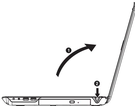
Die Betriebsanzeige informiert Sie über den Betriebszustand. Unabhängig vom Betriebssystem wird das Notebook ausgeschaltet, wenn der Schalter länger als 4 Sekunden ununterbrochen betätigt wird.
