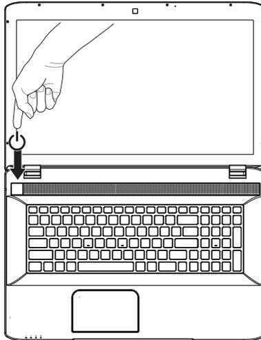
Die Betriebsanzeige informiert Sie über den Betriebszustand. Unabhängig vom Betriebssystem wird das Notebook ausgeschaltet, wenn der Schalter länger als 4 Sekunden ununterbrochen betätigt wird.
