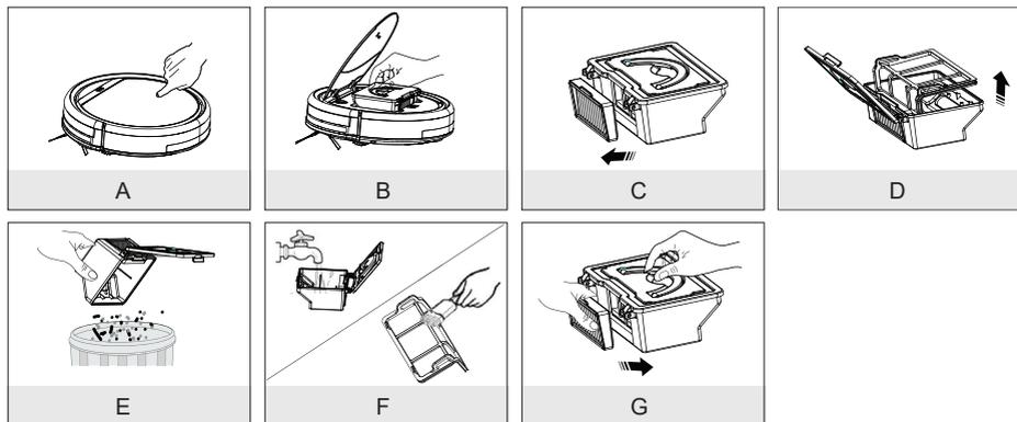
A) Appuyez sur la surface de pression du couvercle de l'appareil portant le symbole de main.
