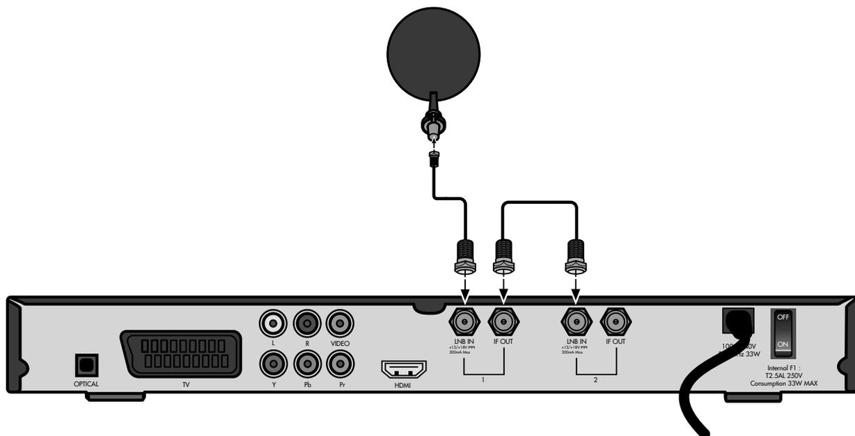
Der Receiver verfügt über zwei Empfangsteile. Um beide nutzen zu können, schließen Sie die Antenne wie folgt an:
