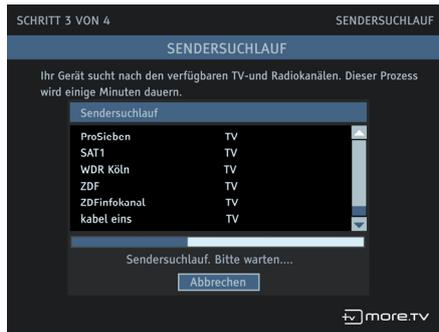
Entsprechend Ihren Ländereinstellungen führt die Set-Top-Box in Schritt 5 eine automatische Kanalsuche aus. Diese dauert etwa 5 Minuten. Der Fortschritt des Suchvorgangs wird in dem Balken unterhalb der Kanalliste angezeigt.
