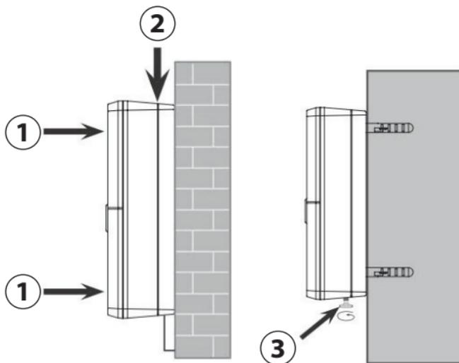
auf die Wandhalterung (1), bis sie hörbar einrastet. Vergewissern Sie sich, dass das Gehäuse rundum dicht geschlossen ist (2) und sichern Sie den Deckel durch Eindrehen der Schraube (3).
