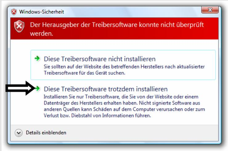
Klicken Sie zur Installation der Treiber auf „**Diese Treibersoftware trotzdem installieren**“.
