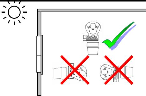
Der Monitor soll niemals in unmittelbarer Nähe der Fenster stehen, weil an dieser Stelle der Arbeitsraum durch das Tageslicht am hellsten beleuchtet ist. Diese Helligkeit erschwert die Anpassung der Augen an den dunkleren Monitor.
