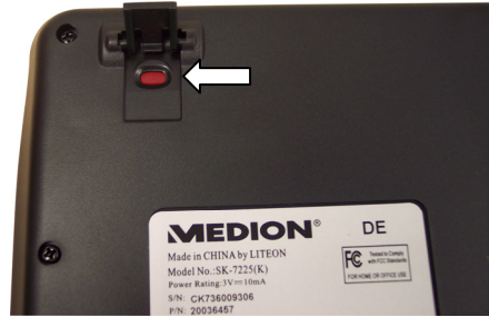
(Abb.: Frequenzabstimmung Tastatur)
