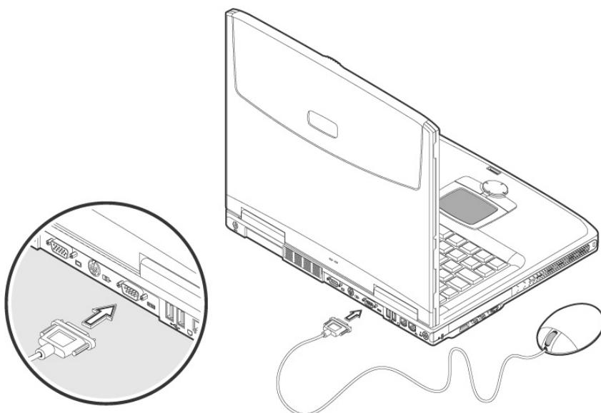
Le port série à 9 broches sert à la connexion de périphériques série tels que modems ou souris. Ce port est désigné par COM1 et gère le protocole de transmission et réception asynchrone 16550.
