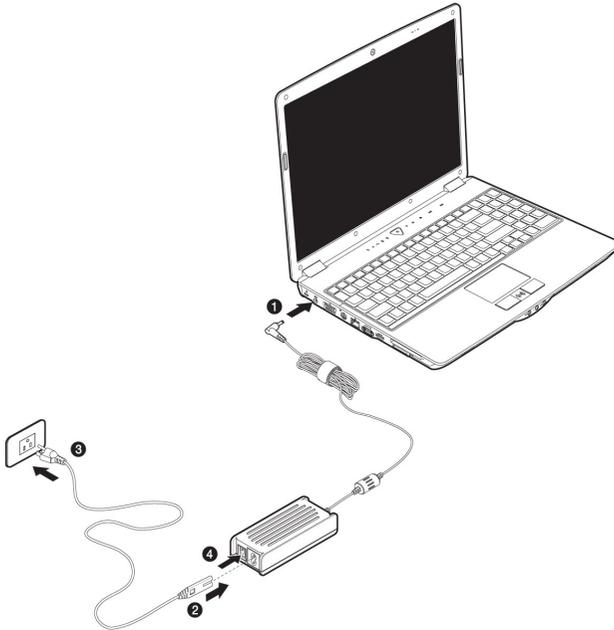
Der Adapter verfügt über einen Ein-/ Ausschalter. Steht der Schalter auf AUS (**0**), wird kein Strom verbraucht und das Notebook wird nicht mit Strom versorgt.
