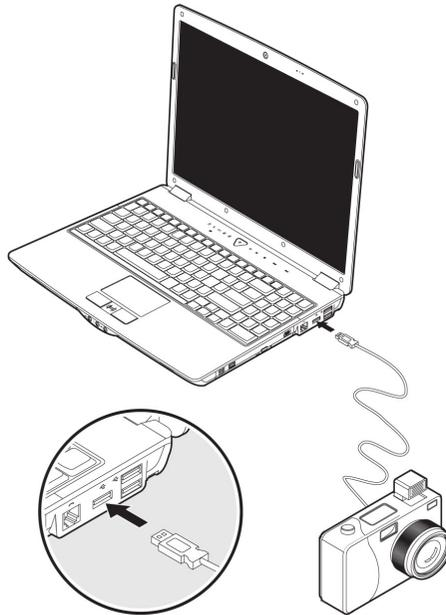
Direkt an den USB-BUS angeschlossene Geräte dürfen einen Strom von max. 500 mA anfordern. Sollten die Geräte eine höhere Leistung benötigen, ist die Anschaffung eines Hubs (Verteiler / Verstärker) erforderlich.
