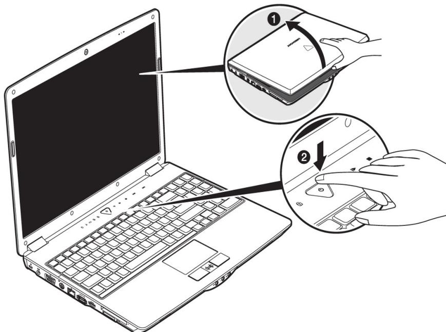
Die Betriebsanzeige informiert Sie über den Betriebszustand. Unabhängig vom Betriebssystem wird das Notebook ausgeschaltet, wenn der Schalter länger als 4 Sekunden ununterbrochen betätigt wird.
