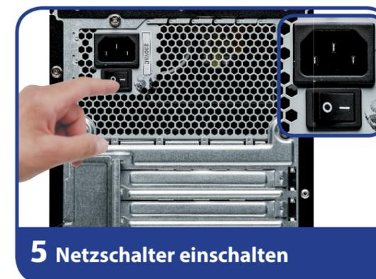
5. Ihr PC-Netzteil hat einen Netzschalter worüber Sie den PC mit Strom versorgen. Stellen Sie den Schalter auf die Stellung I. (Stellen Sie den Schalter auf O, wird die Stromzufuhr unterbrochen.)
