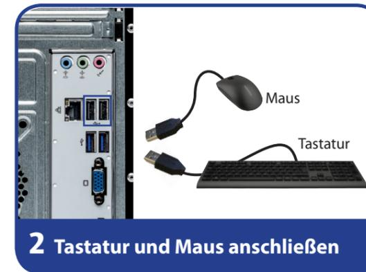
2. Schließen Sie die Tastatur und die Maus an einen freien USB-Anschluss an.
