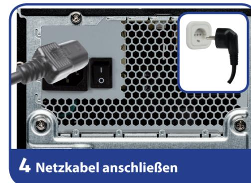
4. Verbinden Sie das Netzanschlusskabel mit dem Netzanschluss Ihres PCs und stecken Sie es anschließend in eine Steckdose. Diese muss sich in der Nähe des PCs befinden und leicht erreichbar sein.
