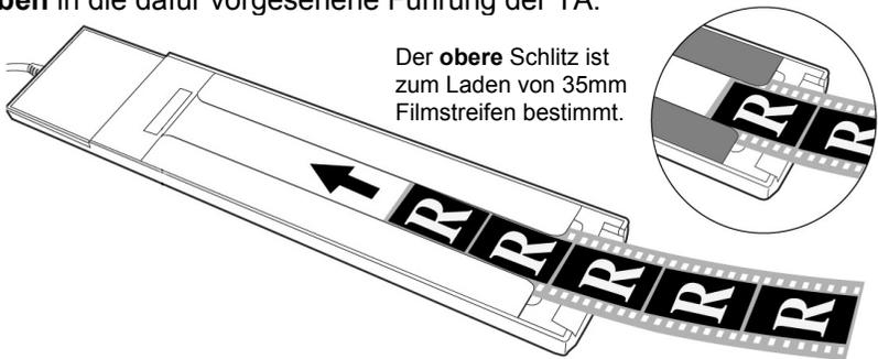
5. Legen Sie die TA vertikal auf die Scanfläche in die Einbuchtung am oberen Lineal des Scanners.
